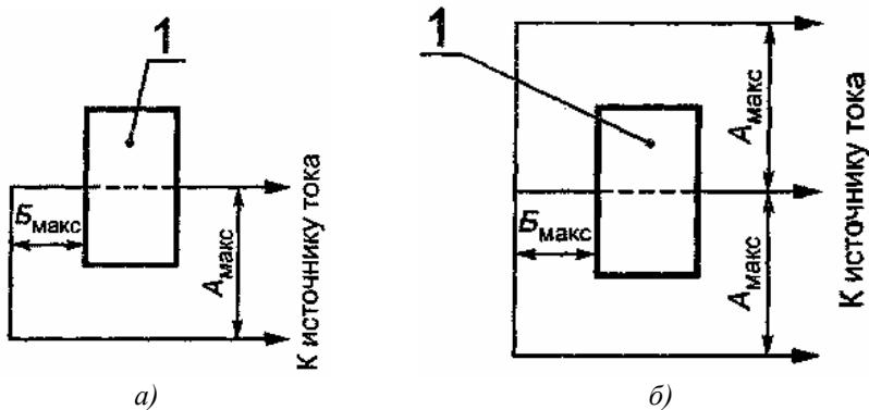
I — испытуемый трансформатор;  $A_{\max}$  — расстояние между осями проводников соседних фаз в месте установки трансформатора в эксплуатации;  $B_{\max}$  — расстояние в свету от трансформатора до места ближайшего изгиба проводника, служащего в эксплуатации первичной обмоткой трансформатора
